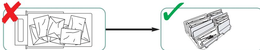
Der Träger für verpackte Instrumente für den STATIM 5000 G4 ist für maximal 12 Autoklavierbeutel vorgesehen. Es ist sicherzustellen, dass das Gesamtgewicht der beladenen Beutel 1,5 kg nicht überschreitet. Der Träger für unverpackt Instrumente fass, nach Einstecken der max. 10 Stati-Dri-Platten, 10 Autoklavierbeutel. Es ist sicherzustellen, dass das Gesamtgewicht der beladenen Beutel 1,5 kg nicht überschreitet..
