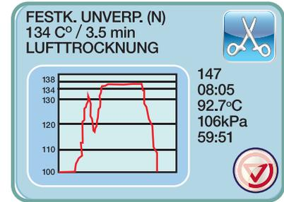
Wenn die automatische 60-minütige Lufttrocknungsphase beendet und der Sterilisationsvorgang erfolgreich ist, erscheint auf dem Touchscreen die Meldung Zyklus beendet und ein Erinnerungston ist zu hören, bis die STOP-Taste gedrückt wird oder die Kassette aus dem Gerät genommen wird.
