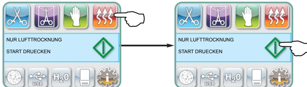
Zum Start des Programms drücken Sie zunächst die Taste Nur Lufttrocknen und dann die **START**-Taste.
