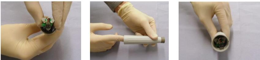
5. Lors de l'assemblage du raccord moteur, placez les connecteurs avec précaution et connectez le raccord moteur avec la garniture de flexible. Veillez à ce que les connecteurs soient orientés correctement dans le même sens de manière à ce que les broches de contact ne soient pas endommagées.
