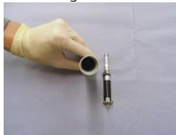
3. Séchez la zone des canaux d'écoulement à l'aide d'un pinceau. Essuyez ensuite l'ensemble du groupe moteur, le boîtier du moteur et la garniture de flexible à l'aide d'un chiffon de nettoyage adapté.
