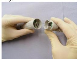
2. Retirez l'ensemble du groupe moteur avec le mécanisme de serrage du boîtier de la pièce à main.
