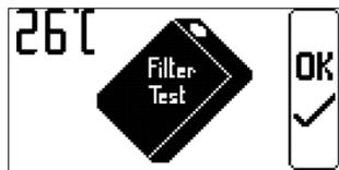
La température de la turbine dans la chambre d'aspiration est affichée dans le coin supérieur gauche. Si le sachet filtrant est trop rempli, un message sur l'écran vous avertira de le changer.
