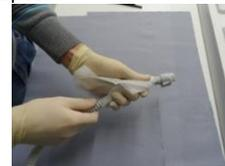
4. Remettez le groupe moteur en place. Lors de l'assemblage de la pièce à main, orientez l'unité moteur à l'aide des rails de guidage du boîtier de moteur. Une seule orientation permet une introduction ne requérant que peu de force.
