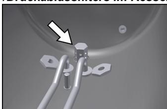
Wenn Sie den Autoklav im Kreislauf-System betreiben, reinigen Sie den Filter im Kessel vierteljährlich, bei Betrieb im Einweg-System halbjährlich.
