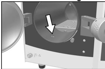
Wenn Sie den Autoklav im Kreislauf-System betreiben, reinigen Sie den Filter im Kessel vierteljährlich, bei Betrieb im Einweg-System halbjährlich, indem Sie den Filter herausschrauben und unter fließendem abspülen.
