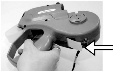
10. Entfernen Sie das erste bedruckte Etikett, das aus der Führung kommt. Es ist mehrfach überdruckt.
