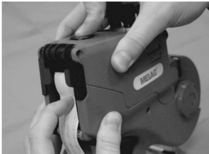
7. Knicken Sie das freie Ende des Etikettenstreifens etwas nach unten um.
