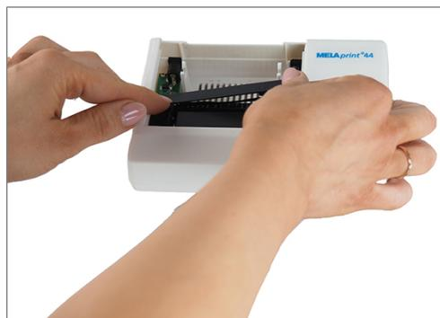
6. Überprüfen Sie das Farbband auf korrekten Sitz. Spannen Sie das Farbband nach Bedarf durch Drehen des Transportknopfes in Pfeilrichtung.
