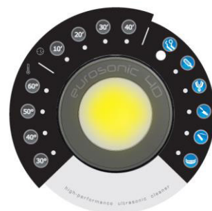
Lumière jaune clignotante. Température du liquide de la cuve élevée par rapport à la température du cycle sélectionné. Attendre le refroidissement.
