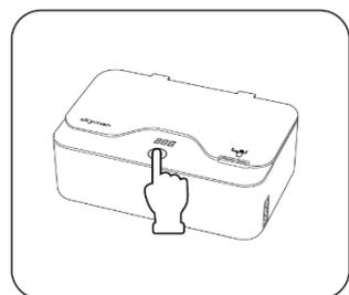
Nachdem Sie die Reinigungszeit eingestellt haben, drücken Sie den Startknopf um das Gerät zu starten. Um den Reinigungsprozess anzuhalten drücken Sie den Startknopf. Mit nochmaligem Drücken des Startknopfes wird der Reinigungsvorgang fortgeföhren. Das Gerät nimmt die Arbeit dort wieder auf wo es stehen geblieben ist. Das Gerät stoppt nach Abschluss des Reinigungsprozesses automatisch. Wenn Sie wieder reinigen möchten, drücken Sie den Startknopf erneut.
