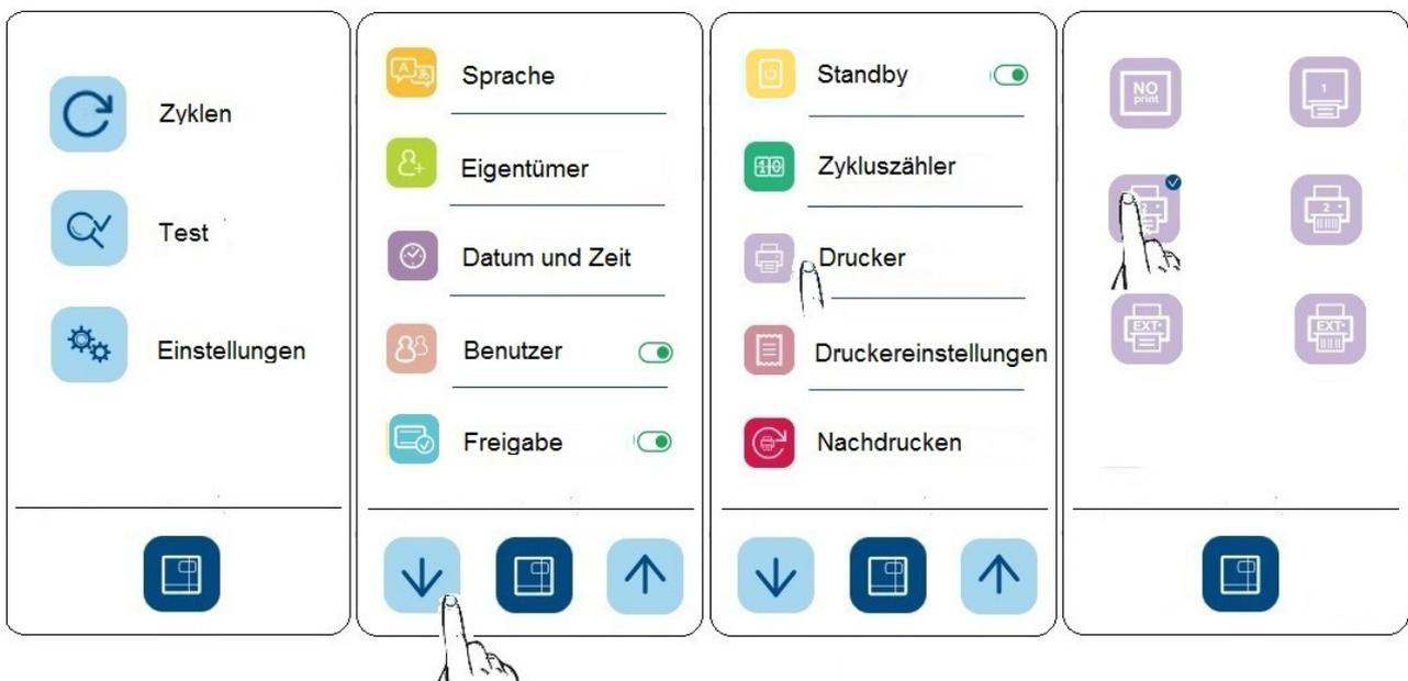
Nach erfolgter Auswahl des Druckers wird bei jedem Zyklusende ein Druckbeleg oder die Anzahl der vorgegebenen Etiketten zuzüglich einer "Zustandsetikette" ausgedruckt, mit dem das Ende des Zyklus bescheinigt wird.
